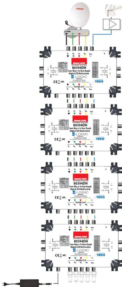
Tutte le linee di passaggio dell'LNB devono sempre essere in cascata o terminate con una resistenza di chiusura isolata a 75 Ohm. Tutte le porte SCR/Legacy inutilizzate devono essere terminate con una resistenza di chiusura a 75 Ohm.
