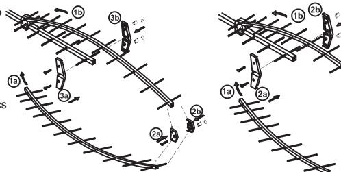
Inserire nella sede in plastica le due culle curve dalla parte dove gli elementi sono più ravvicinati. Posizionare le plastiche 2a e 2b in corrispondenza dell'ultimo elemento della curva centrale e serrare con le relative viti.
