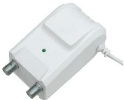
Alimentatori lineari stabilizzati adatti per la telealimentazione, tramite cavo coassiale, di amplificatori TV. Le dimensioni molto contenute permettono di incassarli o fissarli a parete e retro TV. Tutti i modelli sono provvisti di protezione contro il corto circuito e dotati di connettori F.
