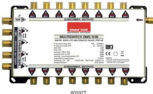
Multiswitch con uscite legacy per impianti radiali, ideali per la realizzazione di impianti "Dual Feed" condominiali dove le tubature per i cavi TV di ciascun appartamento sono collegate direttamente ad un vano tecnico oppure al sottotetto.
