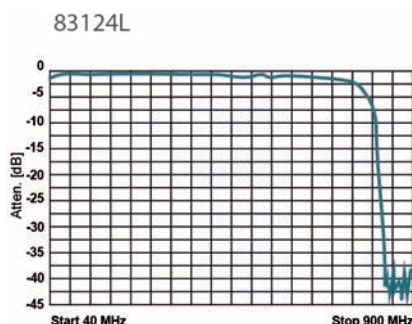
Versione LTEfree, Log periodic con filtro stub tuning. Version LTEfree, Log périodique avec filtre stub tuning.
