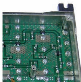
Particolare interno dell'amplificatore. Inside of the amplifier.
